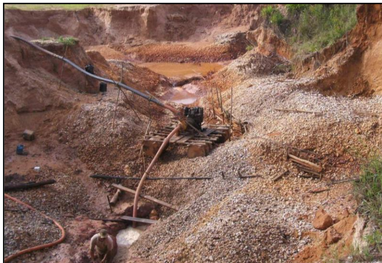
Figura 12. Bomba que faz a sucção do cascalho. Fonte: BASTOS, Beatriz Regina Nunes Perrone (2009).
