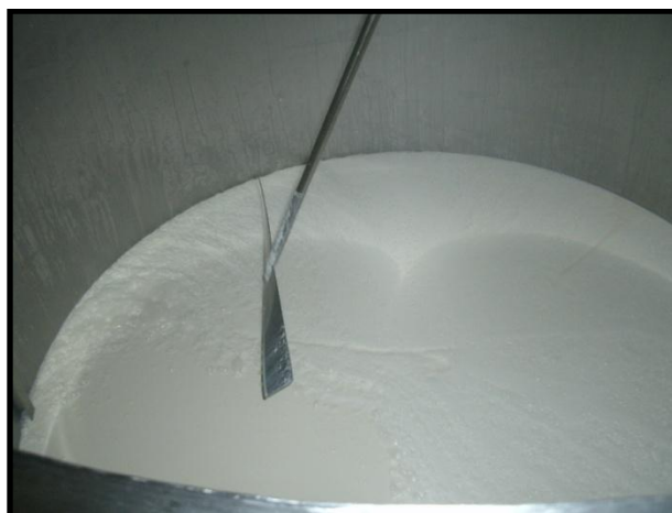
Fig. 20. Tanque resfriador Fonte: ROCHA, Josemir Paiva, 2010.
